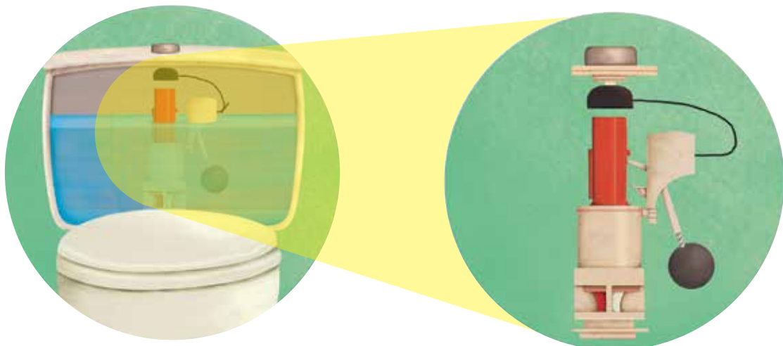
Sistema dual en el tanque del excusado
